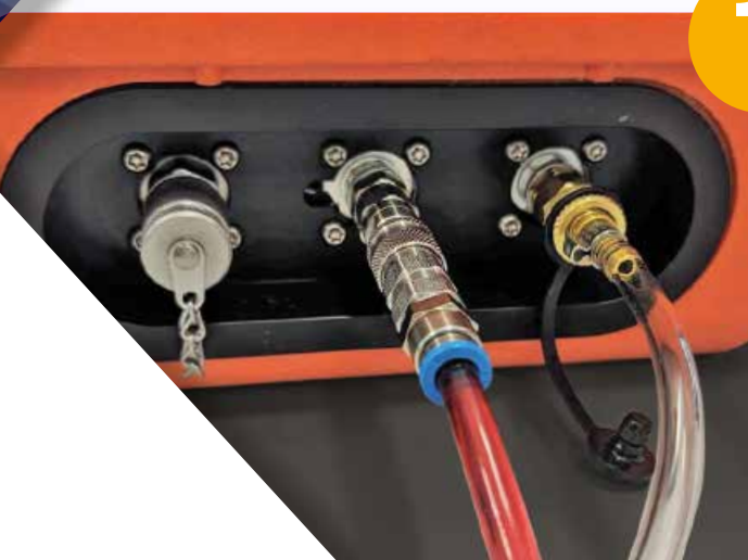
Raccordo di aspirazione e scarico rifiuti in uso
