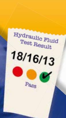
**Solo 10 grammi di polvere di prova (MTD) sono necessari per portare 10.000 litri di fluido pulito (0/0/0) a ISO 19/17/14 (livello che potrebbe potenzialmente causare guasti)**
