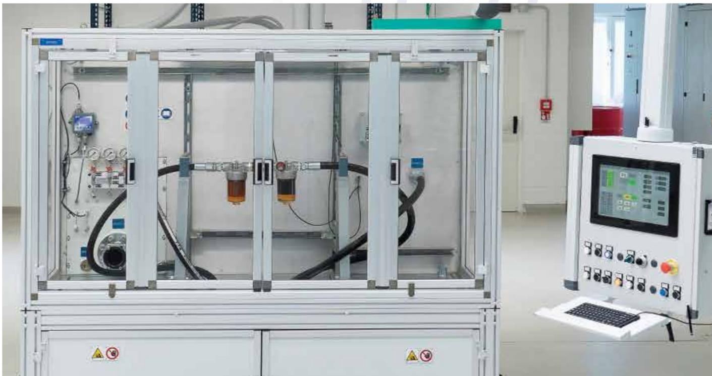
Lo specifico sistema idraulico e gli strumenti di misura utilizzati sono capaci di misurare e registrare il potenziale elettrico generato quando un filtro è attraversato da una portata di olio, misurato in kV.
