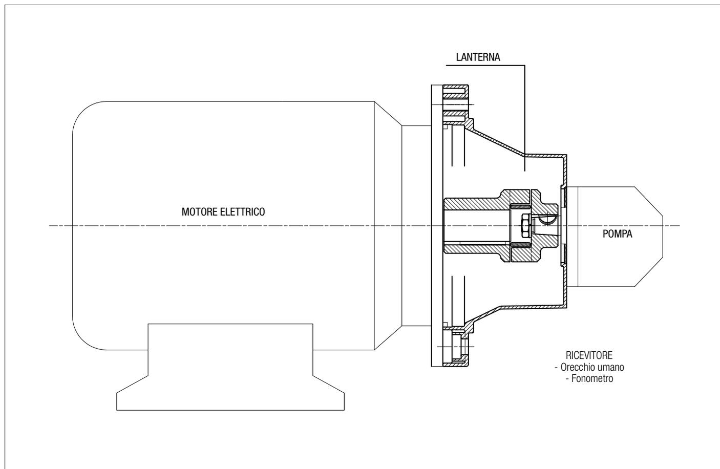
Le lanterne silenziate contribuiscono ad abbassare la trasmissione delle vibrazioni ed il livello di rumorosità dell'impianto.
