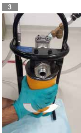
Avvitare la cartuccia fino a quando la guarnizione arriva a contatto con la testata e ruotare di mezzo giro
