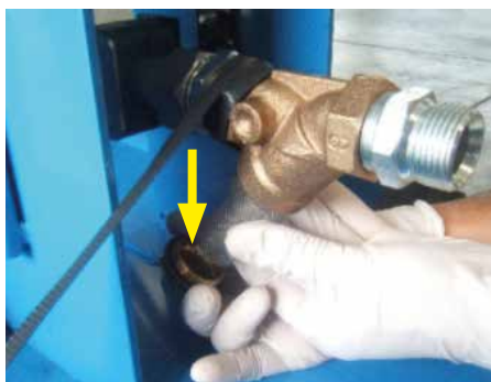
Svitare il dado e sfilare l'elemento filtrante
