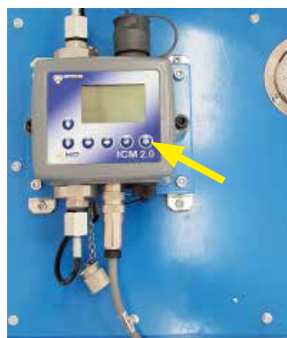
Attivazione manuale del conteggio delle particelle Fig.16
