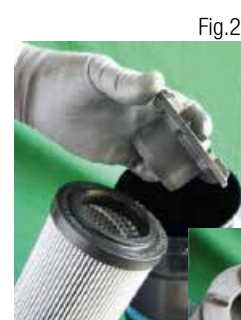
4 Sfilare l'elemento filtrante
