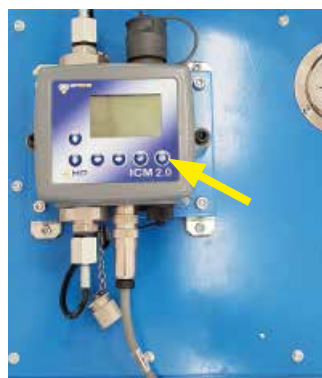
Attivazione manuale del conteggio delle particelle
