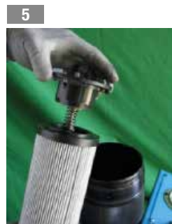
5 Sfilare il bypass o codolo cieco
