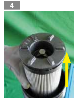
4 Sfilare l'elemento filtrante
