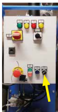
Start/Stop pompa ausiliaria per contatore di particelle Fig.14
