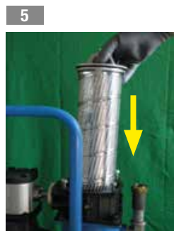
5 Inserire l'elemento filtrante nel filtro
