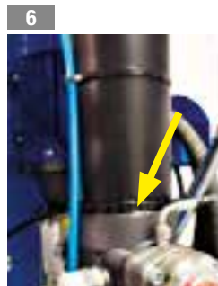
6 Assicurarsi che il contenitore sia ben serrato
