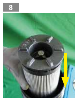
8 Inserire il nuovo elemento filtrante
