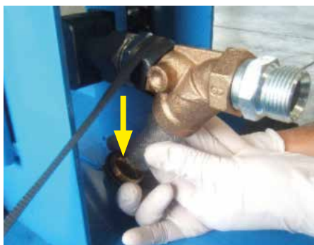
Svitare il dado e sfilare l'elemento filtrante
