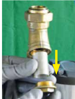
Svitare il dado e sfilare l'elemento filtrante
