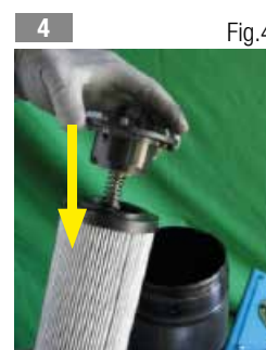
4 Inserire il codolo con bypass (fig.4) o l'eventuale codolo cieco (fig.5) nell'elemento filtrante
