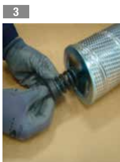
3 Inserire la molla bypass
