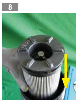
8 Inserire il nuovo elemento filtrante
