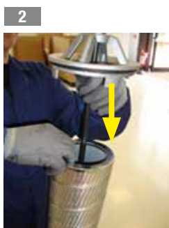
2 Inserire il cavalletto nell'elemento filtrante
