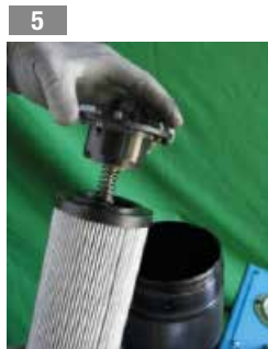
5 Sfilare il bypass o codolo cieco
