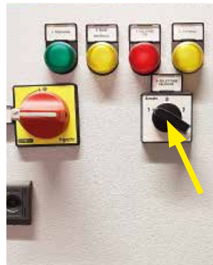
Invertitore di fase solo versione con contatore di particelle ICM2.0
