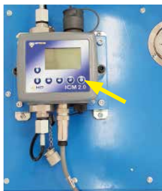
Attivazione manuale del conteggio delle particelle Fig.15
