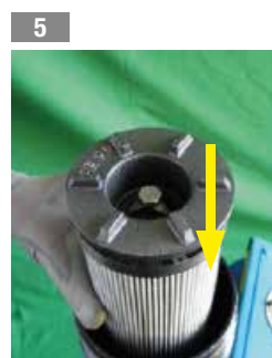
5 Inserire l'elemento filtrante nel corpo filtro
