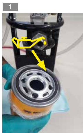
Lubrificare la guarnizione della cartuccia con il fluido di utilizzo
