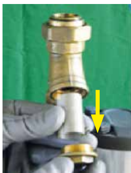
Svitare il dado e sfilare l'elemento filtrante
