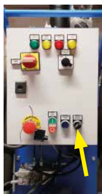
Start/Stop pompa ausiliaria per contatore di particelle
